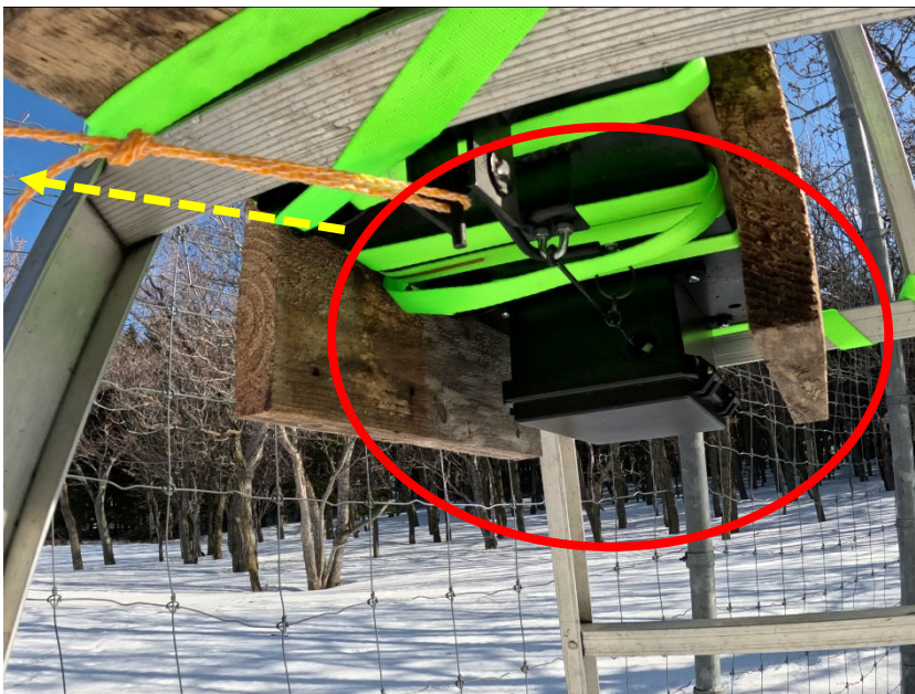
写真 1-3. 五湖側マンゲートに装着した遠隔操作トリガー（赤丸部）
