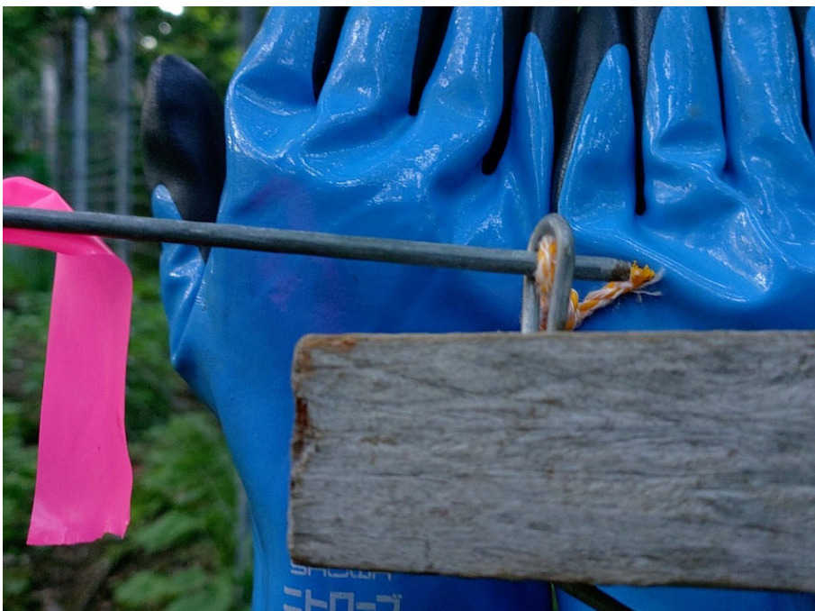
写真Ⅱ-6. マンゲート扉部に接続したけり糸末端のトリガー（捕獲機構）（2025年6月25日）
