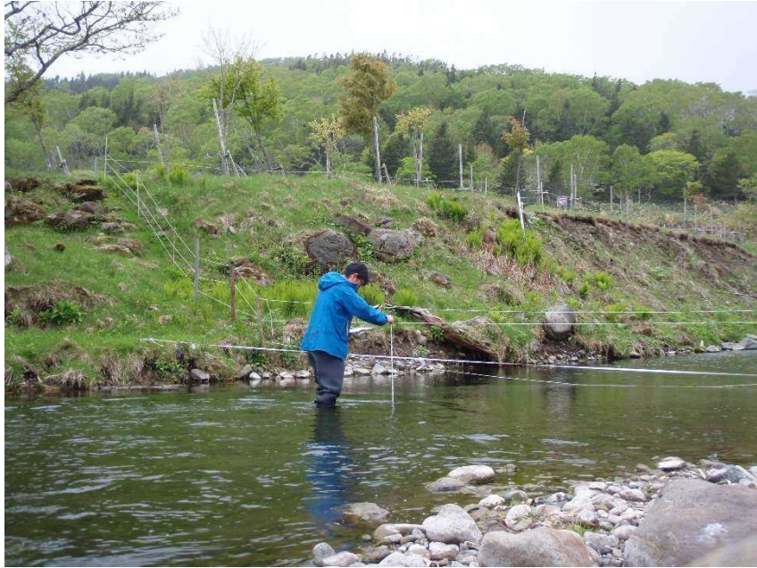
写真 2. 河川横断面積を測量する様子
