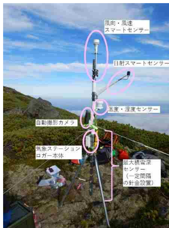
気象観測システム設置時の写真
