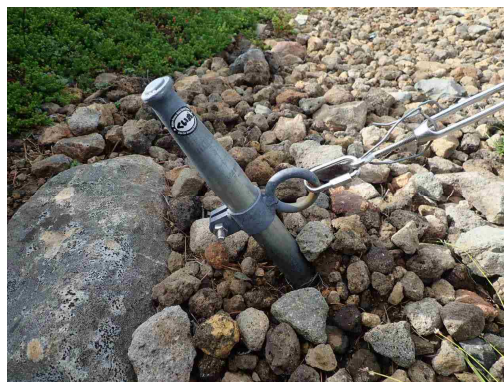
北見工業大学気象観測装置(固定状況)
