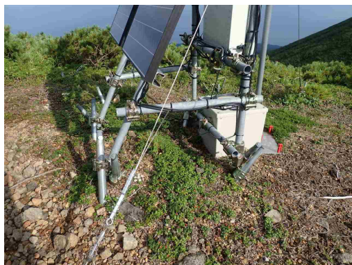
北見工業大学気象観測装置(固定状況)
