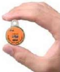
ティドビット V2 は、超小型の水溫計測用データロガーです。
