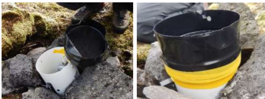
写真 23：確認時の雨量計、蓋が外れ変形していた（写真左）、雨量計の再設置後（写真右）
