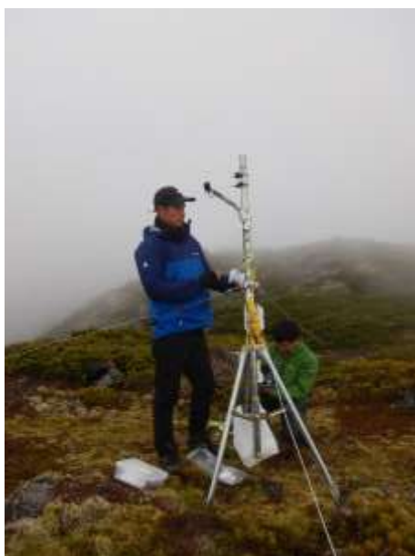
写真6：STP04 で気象観測システム動作確認の様子
