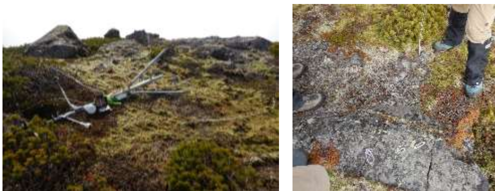
写真 19：倒れていたトリポット（写真左）と、不自然に外れていたワイヤーロープテンショナー（写真右）
