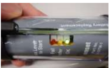
写真 10 : 緑色の LED が点滅 (ロガー情報読み取り成功)
