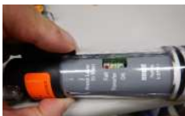
写真 8 : Coupler lever をしなる程度に押す
