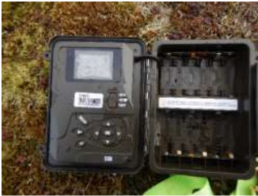
写真 22：バッテリー部分が錆びてしまった自動撮影カメラ (電池を外した状態)
