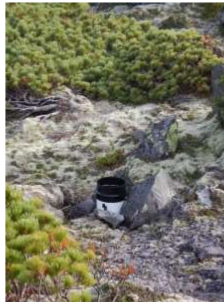
写真 2 : SR-8 で温度ロガー設置の様子
