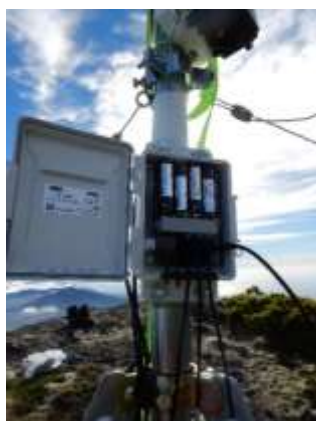
写真 17：各センサーを気象ステーションロガーに接続している様子（写真左）と、PC と接続して各センサーの状態を表示している様子（写真右）
