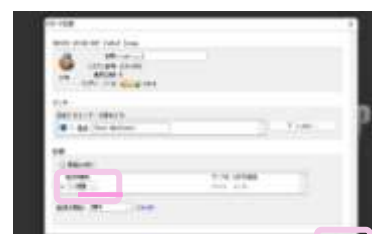
写真 12 : 記録間隔を 1 時間とし、「開始 (即時の場合)」もしくは「タイマースタート (日時設定の場合)」を押す
