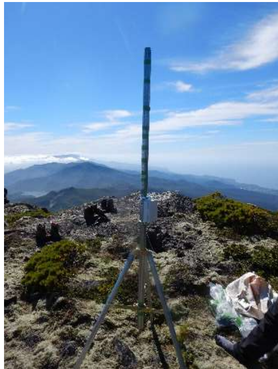
写真14：トリポットを設置した状態（写真左上）、マストをトリポットにはめて固定した状態（写真右）、マストをワイヤーで固定している様子（写真左下）
