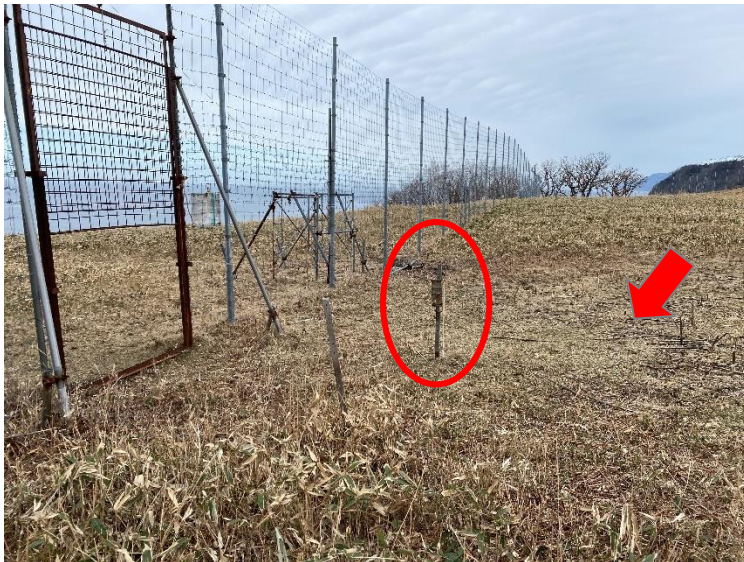
写真 I-18. 落下式ゲートに装着した捕獲装置（赤丸部）とけり糸（矢印）（2022 年 4 月 15 日撮影）
