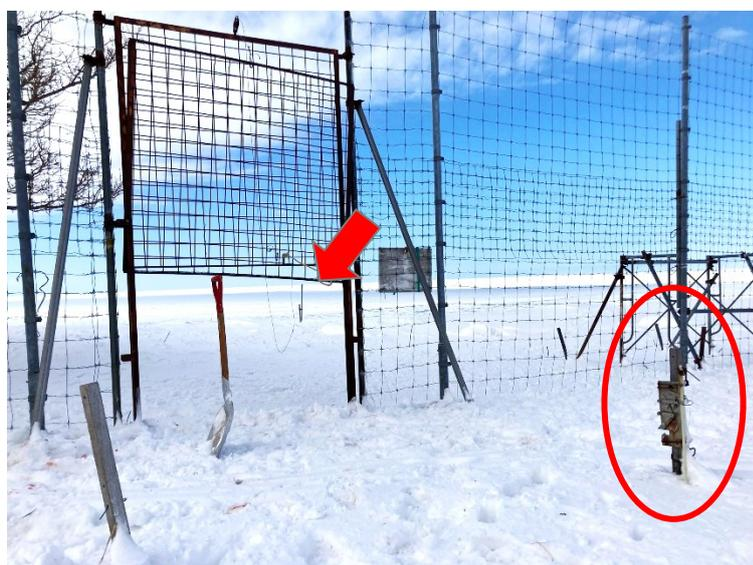
写真 1-2. 落下式ゲートに装着した捕獲装置 (赤丸部) とけり糸 (矢印)
