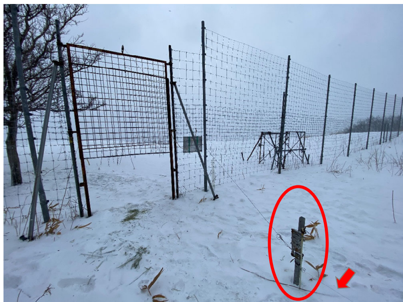
写真 1-2. 落下式ゲートに装着した捕獲装置（赤丸部）と蹴り糸（矢印）（2021 年 2 月 3 日撮影）
