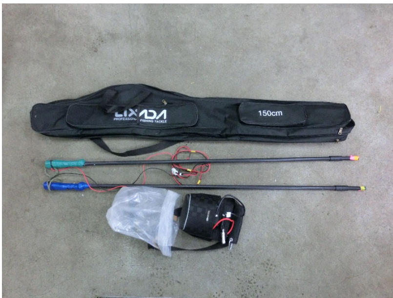
写真 1-12. 使用した電殺機一式（下）と運搬用のケース（上）
