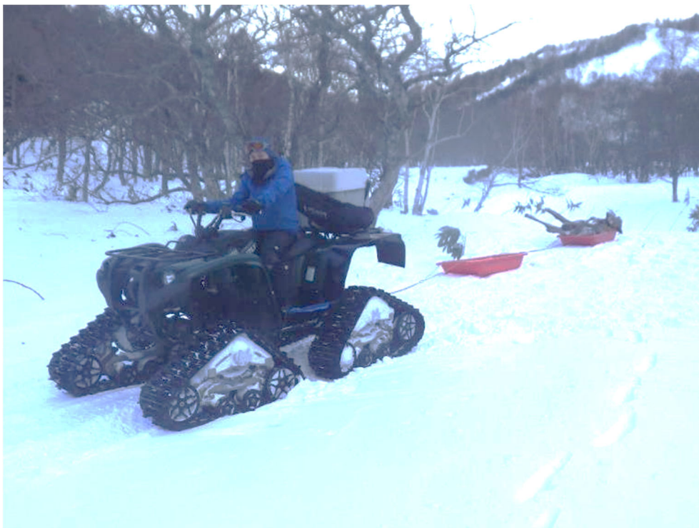
写真 2-7. クローラ付き ATV を用いた捕獲個体の運搬作業の様子 (2021 年 2 月 10 日撮影)
