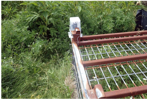
岬地区草原の録音機器の設置
