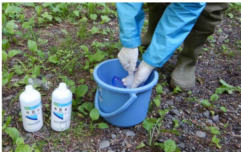
現地でのネガティブコントロール用サンプル作成（精製水使用）
