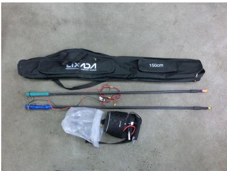
写真 1-2-3. 使用した電殺器（下）と運搬用のケース（上）
