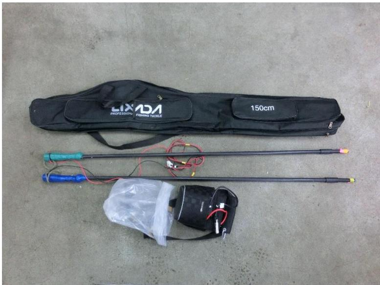
写真 1-3-10. 使用した電殺器（下）と運搬用のケース（上）
