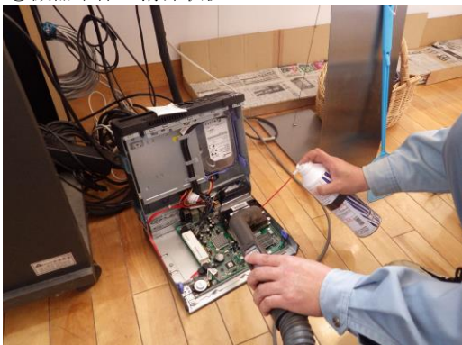
①機器本体の清掃状況
