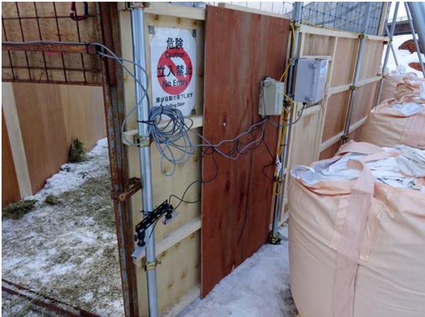
写真 A-2-5. 幌別囲いわなの自動落下式ゲートとセンサー・本体等の配線
