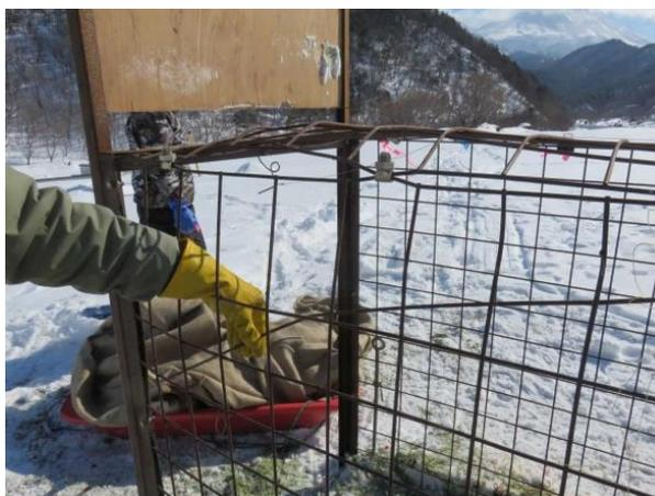
写真 A-4-8. 溶接部が外れてメッシュが破損した箱わな
