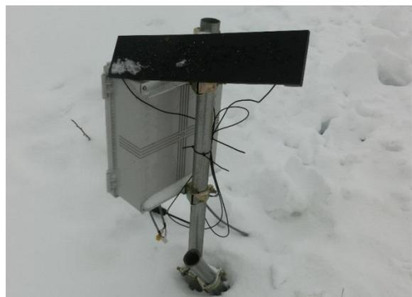
写真 A-1-16. ヒグマによって破損した遠隔捕獲装置 (3月23日撮影)
