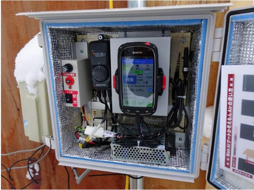
写真 A-2-6. 幌別囲いわなの自動捕獲装置の本体部分 (AI ゲートかぞえもん Air)
