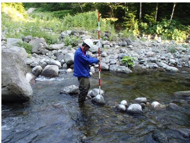
写真 3.5 イワウベツ川上流水位計設置箇所の石礫マーキング
