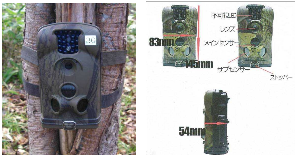
図 3. 自動撮影カメラの概要 (LTL ACORN Ltl-6210MC) (上図左：カメラの設置状況、上図右：日本語マニュアルより製品概要)
