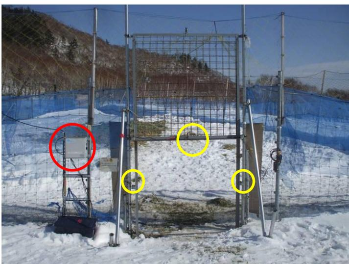
写真 B-1-2. 自動落下式ゲート. 赤丸がシステム本体. 黄丸がトリガーとセンサー.
