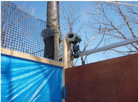
写真 A-1-8. 設置した監視カメラ
