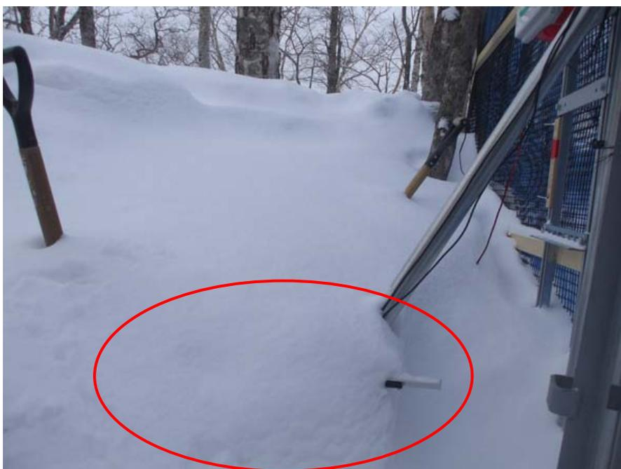
図 B-3-9. 積雪下に完全に埋没した赤外光電センサー.
