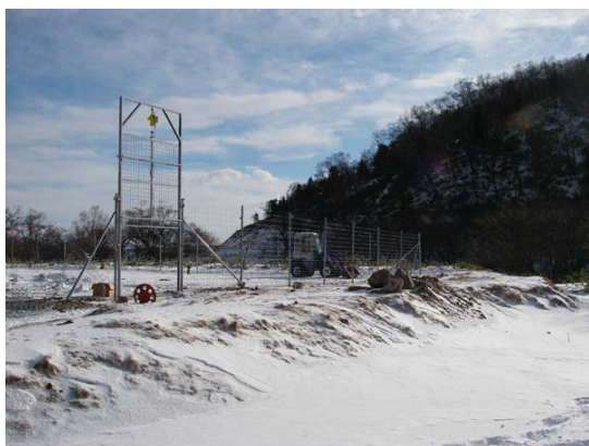
写真 2-7. 遠隔操作で落下可能な落とし扉。
