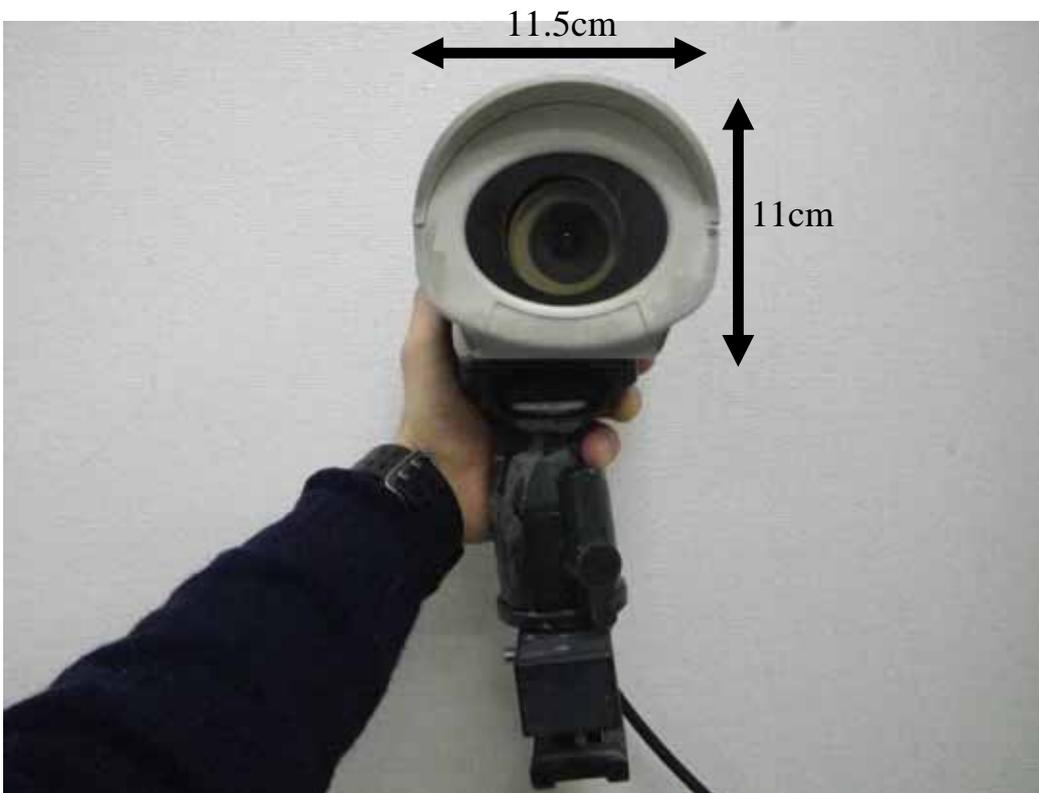
写真 4-3 . 設置したカメラの外観（正面）と寸法
