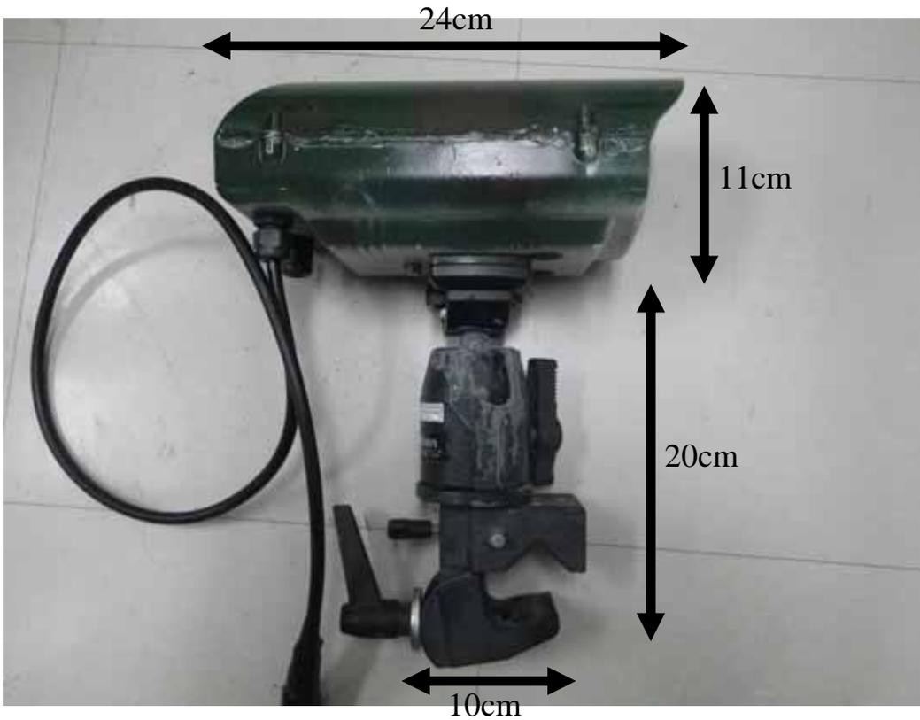
写真 4-2 . 設置したカメラの外観（側面）と寸法
