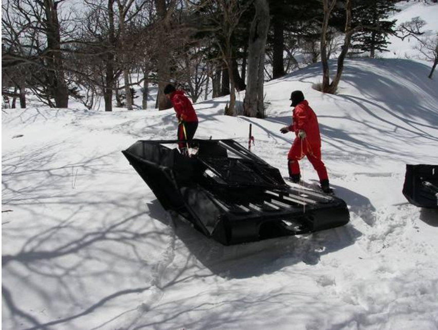
写真 14. 強風で吹き飛ばされ、潰れた箱型ブラインドの回収作業（D 地点，3 月 19 日）。
