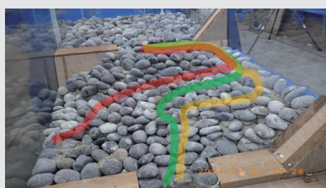
▲斜路形状の石組み魚道模型 ※赤、緑、黄色の線は遡上ルート
