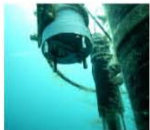
海の調査：海中のようす クロロフィル濃度センサーなど A scene from a marine survey: Under the sea Conducted using a chlorophyll concentration meter
