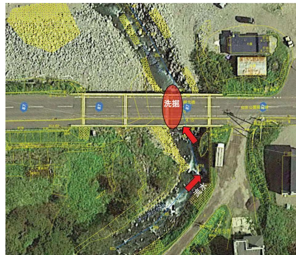
図 洗掘概要図
