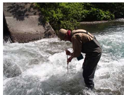
流速測定状況
