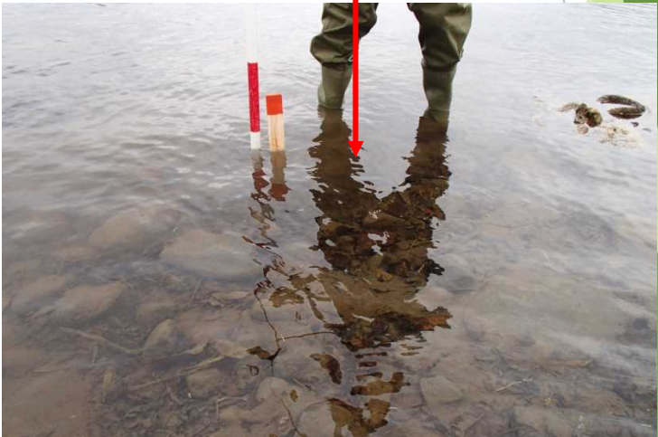
滞水区間の状況 石の凹凸落差は10cm程度 最大水深部は22cm
