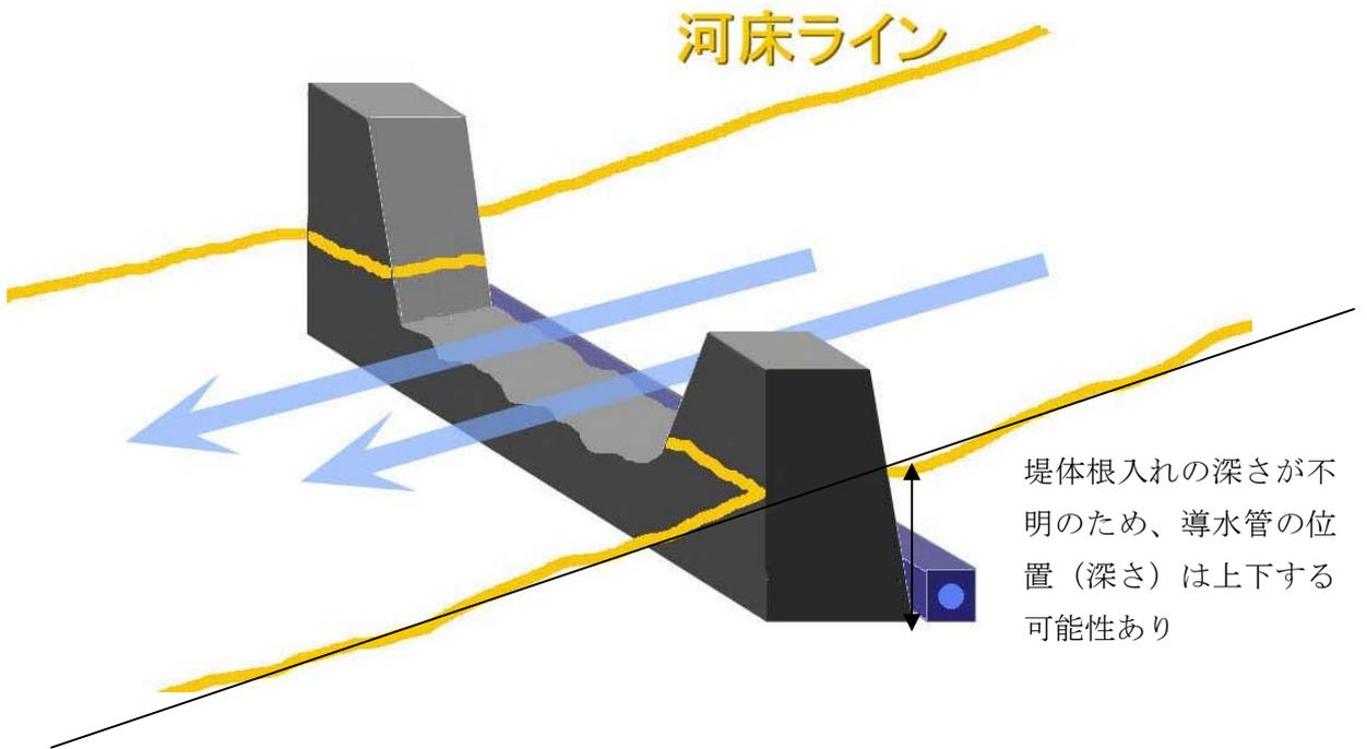
河川工作物詳細図(導水管)
