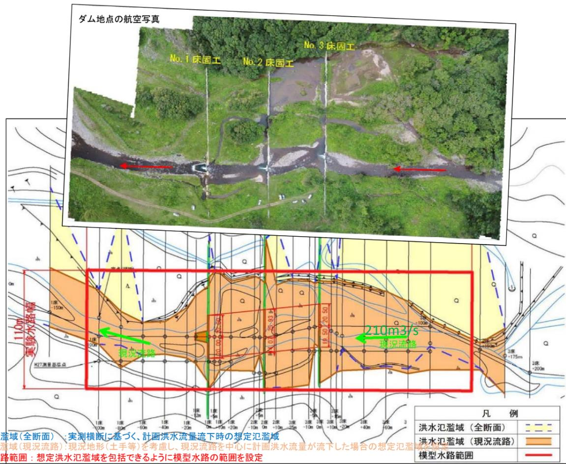
洪水氾濫域(全断面) : 実測横断に基づき、計画洪水流量流下時の想定氾濫域
