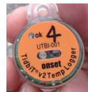
温度ロガー： ティドビットv2
