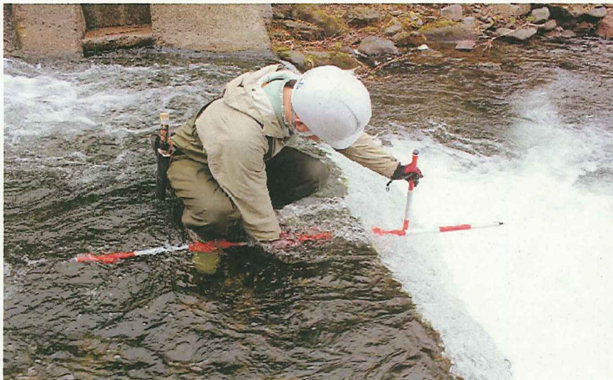
複断面放水路より1.60m洗掘
