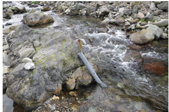
設置した水位計（塩ビ管の中に水位計をセット）
