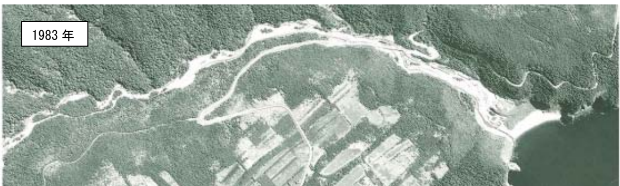
水害から 2 年後の様子。流域の河畔林が喪失し、河道があらわになっている。
