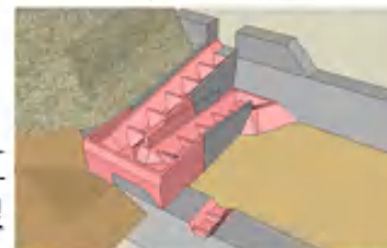
No.2 床固工 魚道の改良
