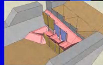
No.1 床固工 魚道の改良
