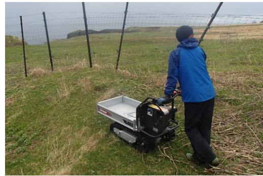
作業効率化のための使用機材例 (小型運搬機)
